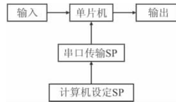
图2 基于 AT89S52 的同步器硬件方框图
