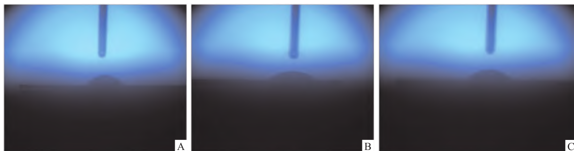
图2 接触角测量图片
